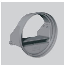
RD BP SM Samodejni regulatorji pretoka. Namestijo se v notranjost manšete šob BDOP. Premer 80 mm. Pretok: 15 ali 30 m 3 /h.
