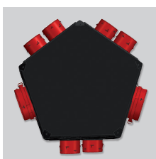
PLENUM UNI EXT 6+1 Izoliran dovodni plenum s priključkom Ø 125/150-160 mm, 1 izhodom za kuhinjo Ø 125 mm in do največ 6 izhodi za kopalnico Ø 80 mm.
